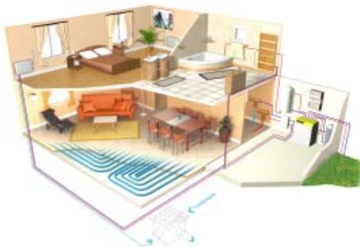
Exemple d'une installation avec un système mixte: Plancher au rez de chaussée et ventilo-convecteurs à l'étage
